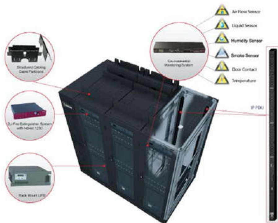
รูปที่ 11. Mini Data Center พร้อม อุปกรณ์ประกอบครบชุด เช่น ระบบดับเพลิงในตู้แร็ค, ระบบ EMS, ระบบเปิดประตูอัตโนมัติ (กรณีอุณหภูมิในตู้แร็คสูงเกินค่าที่กำหนด), UPS เป็นต้น
